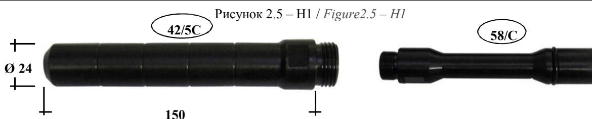
Чтобы получить удлинение 150 мм. достаточно заменить детали следующим:
