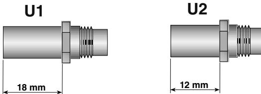
**UGELLO PER RIVETTI S-TRIFAR / X-TRIFAR Ø 5,2** - NOZZLE FOR RIVETS S-TRIFAR / X-TRIFAR Ø 5,2 - BUSE POUR RIVETS S-TRIFAR / X-TRIFAR Ø 5,2 - MUNDSTÜCK FÜR NIETEN TEIL S-TRIFAR / X-TRIFAR Ø 5,2 - INYECTOR PARA REMACHES S-TRIFAR / X-TRIFAR Ø 5,2 - ДЫСА ДЛЯ ЗАКЛЕПКИ S-TRIFAR / X-TRIFAR Ø 5,2
